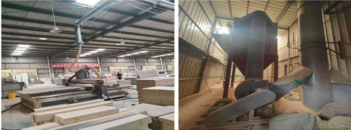
2、打磨废气：侧压抽风收集+水喷淋+15m高排气筒（DA002），现场情况如下：
